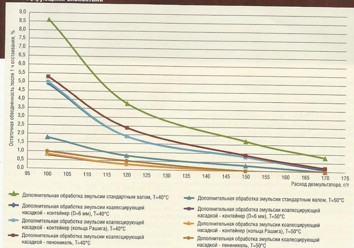
**Рис. 6. Результаты обезвоживания 25%-ной эмульсии «средней» нефти после предварительной обработки коалесцирующими элементами**
